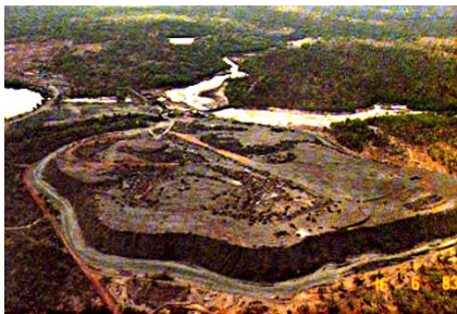
Slika 2. Tehnološki postupak dobijanja (izdvajanja) bakra iz jalovine pomoću specijalnih bakterija. A) Jalovište pored rudnika, 1983. godina. B) Isti prostor posle tretmana izluživanja bakra pomoću bakterija, 1986. godina.
